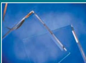
**Technologie à ondes de surface.** Les dalles tactiles IntelliTouch à ondes de surface Elo offrent une solution tactile combinant excellente qualité d'image et précision. Cette technologie est une des plus utilisées dans les applications médicales non critiques et activées par les patients mêmes.
