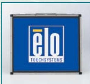
Les moniteurs bornes tactiles Elo sont spécialement conçus pour une intégration aisée dans la console de votre borne. Ces moniteurs sont traditionnellement équipés de la technologie à ondes de surface Elo, qui est beaucoup utilisée dans les applications de bornes.
