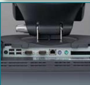
In den Elo All-In-One-Touchcomputern steckt ein komplettes PC-System mit der gleichen Grundfläche wie ein herkömmlicher Monitor. Sie sind leise, lüfterlos und bieten gleichzeitig alle herkömmlichen Schnittstellen und Funktionen in modernem, platzsparendem Design.
