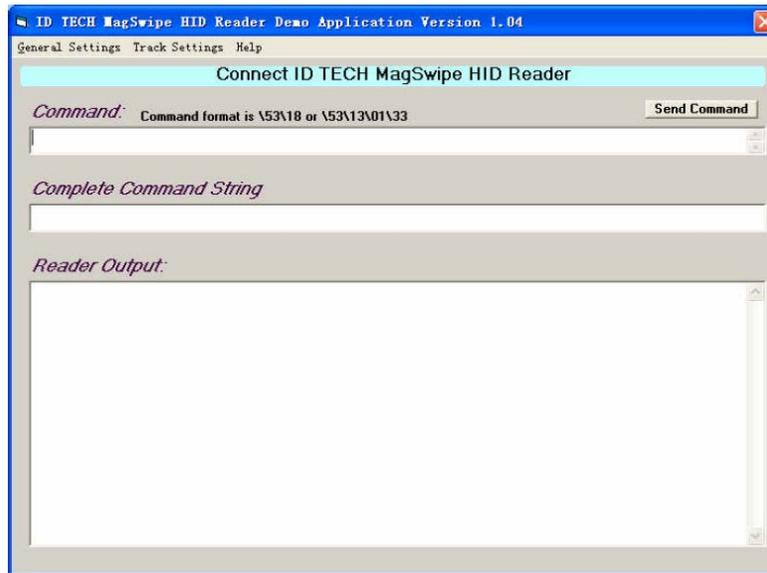
2. Ziehen Sie eine Karte durch den MSR und überprüfen Sie, ob die Daten im Anwendungsfenster angezeigt werden.
