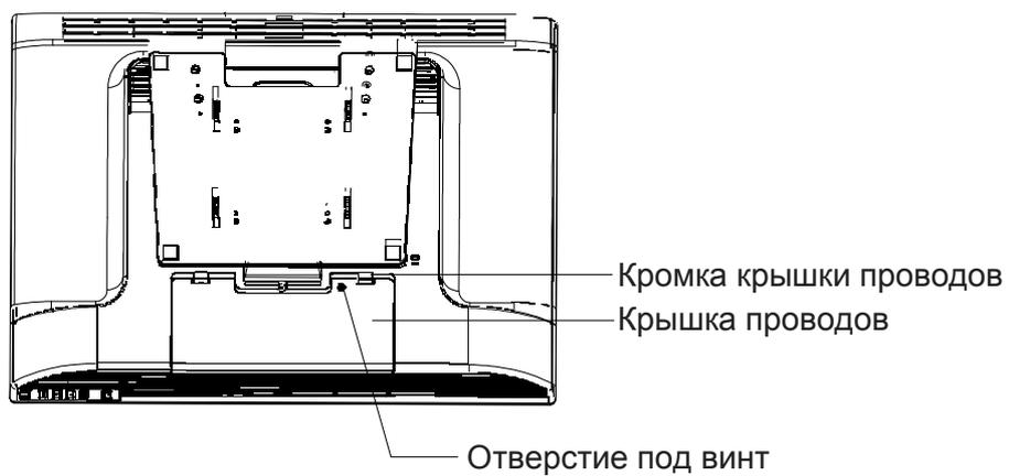
После прикрепления всех проводов к монитору осторожно подведите все провода к подставке, чтобы они поместились под кромкой крышки проводов. Вытащите винт из детали и вставьте его в крышку проводов. Защелкните крышку проводов на место поверх подсоединений.
