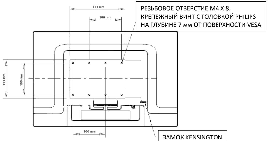
Выше показан вид монитора сзади в горизонтальной ориентации
