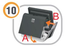
Replace the back door (A), then replace the side door (B).
