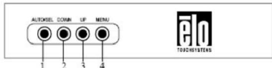
Блок управления отображением выполняемых функций (On-Screen Display - OSD), входящий в ваш комплект, позволяет вам изменять настройки на экране монитора. Он имеет четыре кнопки:
