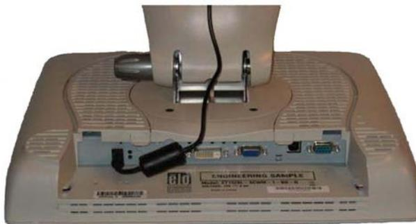
Branchez le connecteur cylindrique de l'adaptateur d'alimentation sur le moniteur.
