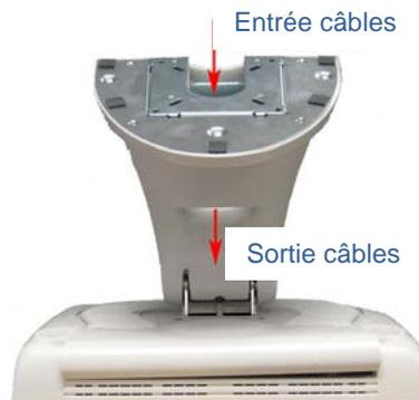
**REMARQUE** Avant de brancher les câbles sur le moniteur tactile, faites cheminer à travers le trou dans l'embase tous les câbles dont vous allez vous servir, comme indiqué sur l'image ci-dessous. N'utilisez que l'un des deux câbles suivants : Câble tactile série ou USB et câble vidéo D-Sub 15 ou câble vidéo DVI.
