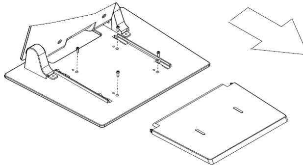
**Option 1 — Montage von oben. Ziehen Sie die Abdeckung des Ständerbodens heraus. Befestigen Sie den Ständer mit 4 Schrauben auf der Oberfläche.**
