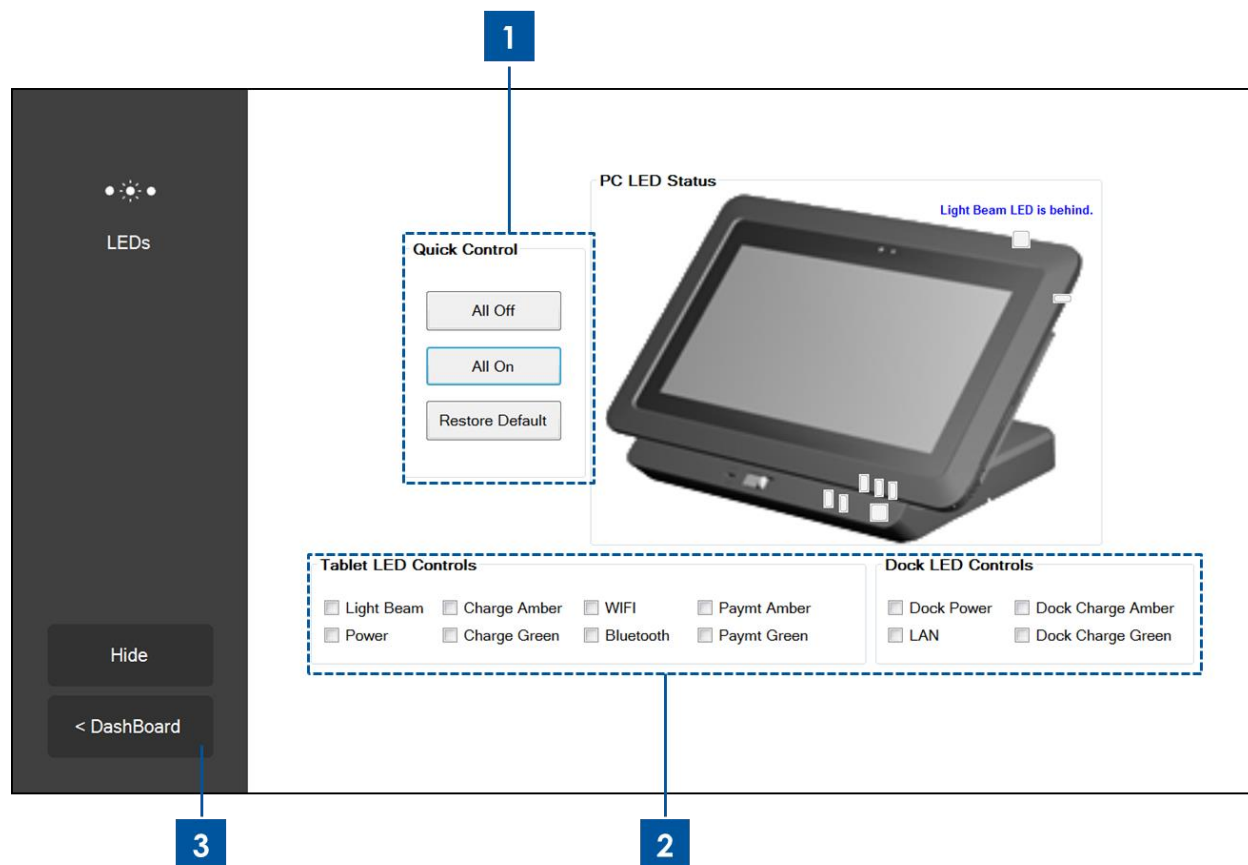
Figura 9e. Applicazione LED della Diagnostic Suite del tablet Elo
