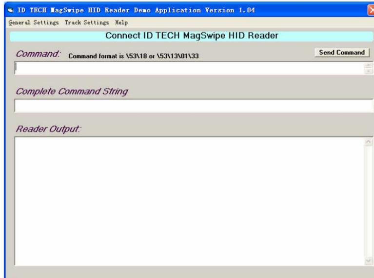
2. Deslice la tarjeta a través del lector de banda magnética y verifique que los datos se muestren en la ventana de la aplicación.
