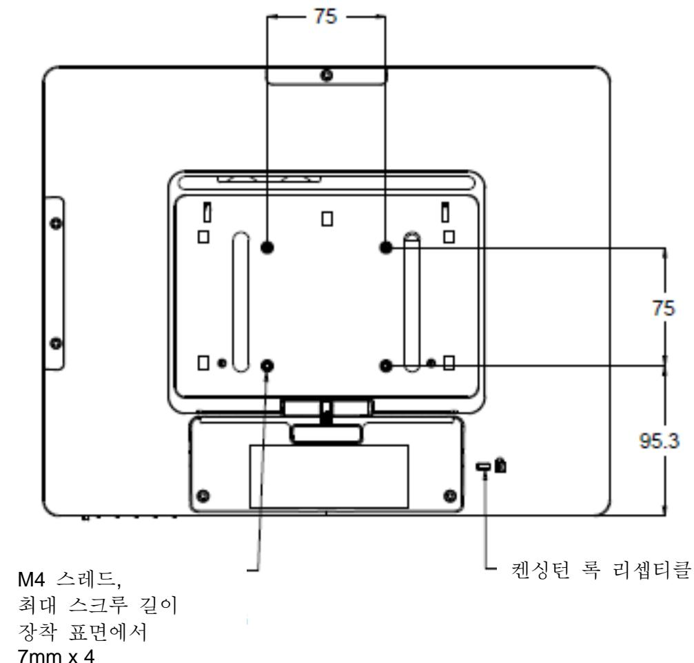
17-인치 터치모니터의 경우, 4개의 구멍이 있는 M4 스크루용 75x75mm 장착 패턴이 모니터의 후면에 제공됩니다. 필립스 스크루드라이버를 사용해서 스탠드를 제거하면 이 장착 인터페이스에 접근할 수 있습니다. VESA FDMI-준수 장착 코드는 다음과 같습니다: VESA MIS-B, 75, C.
