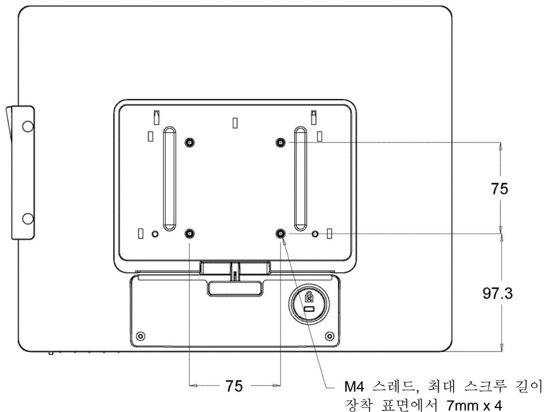
17 인치 터치모니터의 경우, 4개의 구멍이 있는 M4 스크루용 75x75mm 장착 패턴이 모니터의 후면에 제공됩니다. 필립스 스크루드라이버를 사용해서 스탠드를 제거하면 이 장착 인터페이스에 접근할 수 있습니다. VESA FDMI-준수 장착 코드는 다음과 같습니다: VESA MIS-B, 75, C.
