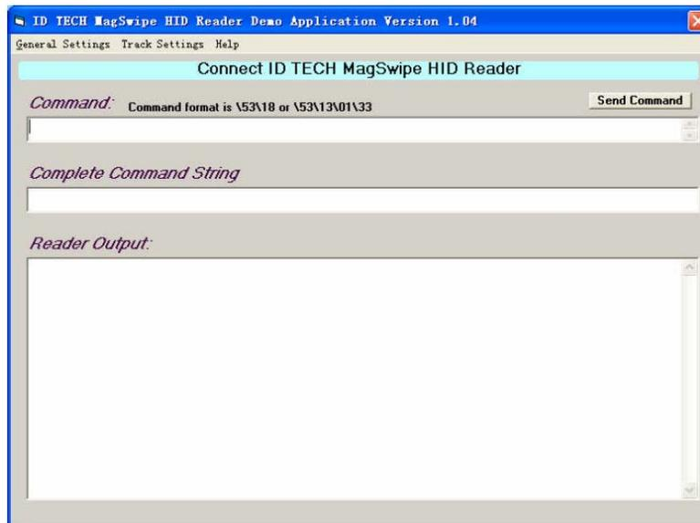
2. Проведите карточкой через устройство считывания магнитных полос и проверьте, чтобы данные были отображены в окне приложения.
