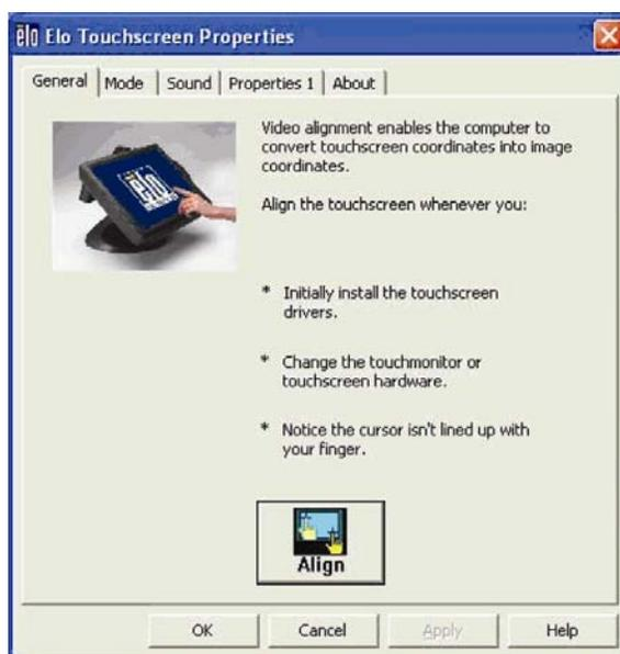
Нажмите кнопку **Выравнивание (Align)**. Это запустит программу калибровки. Откроется окно, показанное внизу. Выполните инструкции для калибровки сенсорного экрана.
