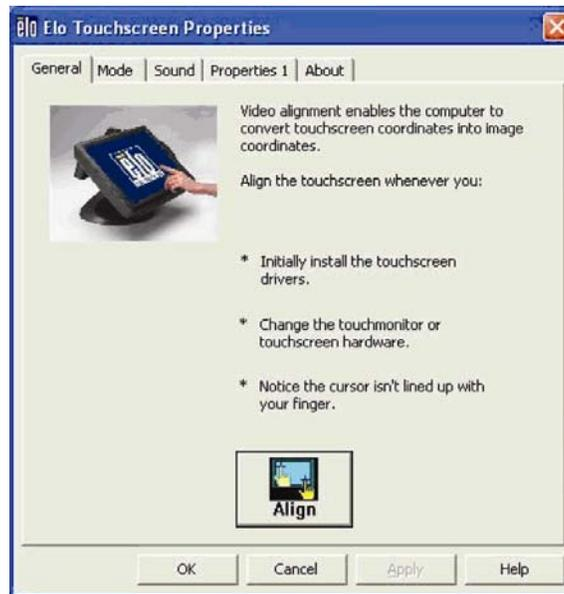
Klicken Sie auf **Align** (Ausrichten). Das Kalibrierungsprogramm wird gestartet. Das nachstehend gezeigte Fenster öffnet sich. Folgen Sie den Anweisungen zur Kalibrierung des Touchscreens.
