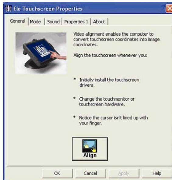
Scegliere il pulsante **Align** (Allinea). In tal modo viene avviato il programma di calibrazione. Si apre la finestra visualizzata oltre. Per calibrare lo schermo, seguire le istruzioni.
