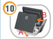
Replace the back door (A), then replace the side door (B).
