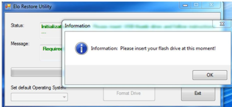
4. Nach dem Anschluss des Flash-Laufwerks blendet sich das nachstehende Fenster ein. Klicken Sie auf „Format Drive (Laufwerk formatieren)“, um den Vorgang fortzusetzen. **BEACHTEN SIE BITTE, DASS DADURCH ALLE DATEN AUF DEM FLASH-LAUFWERK GELÖSCHT WERDEN.**
