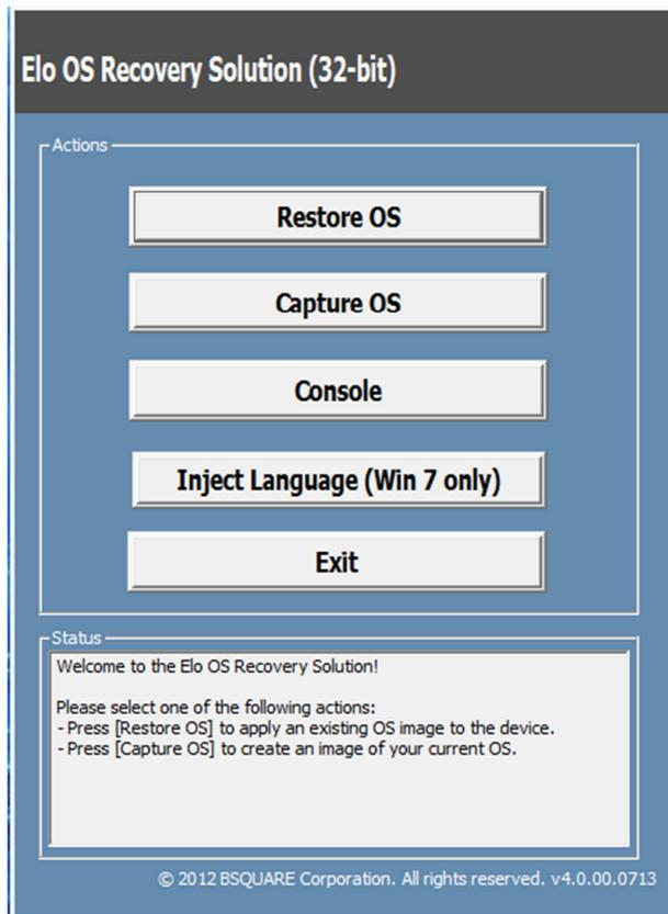
6. Wählen Sie **Restore OS (Betriebssystem wiederherstellen)**. Das System testet Ihre Hardware automatisch. Sobald der Vorgang abgeschlossen ist, klicken Sie auf **Start**, um die Funktion zur Systemwiederherstellung auszuführen.
