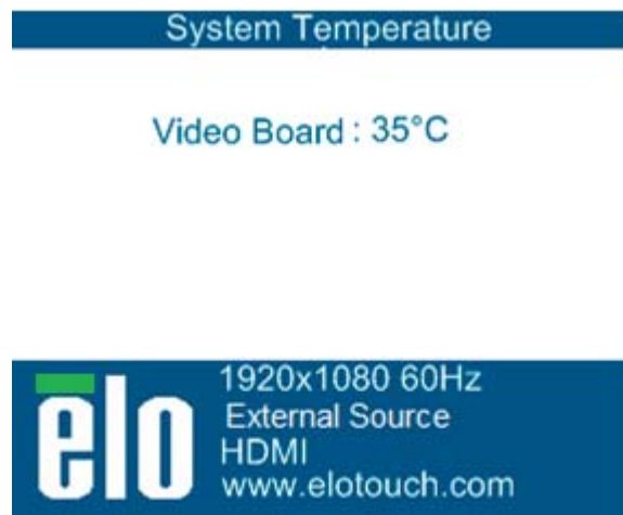
Ejemplo de OSD donde se muestra la Temperatura de la Placa de Vídeo
