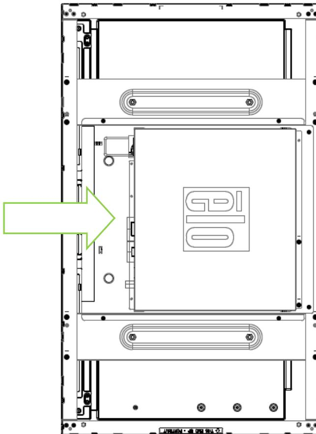
Горизонтальное направление возможно только в положении 0 градусов так, что логотип Eio на задней панели не развернут, а кабели подключены снизу, как показано на следующем рисунке.
