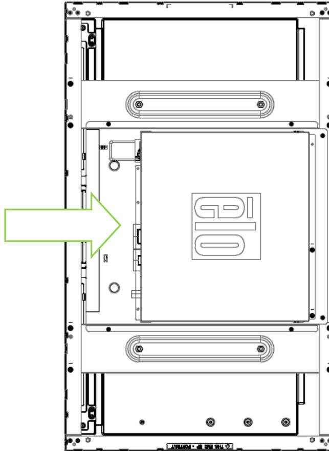
El modo horizontal solamente se puede instalar con un ángulo de 0 grados de forma que el logotipo de Elo situado en la parte posterior no se gire desde la parte inferior, tal y como se muestra en la imagen siguiente.
