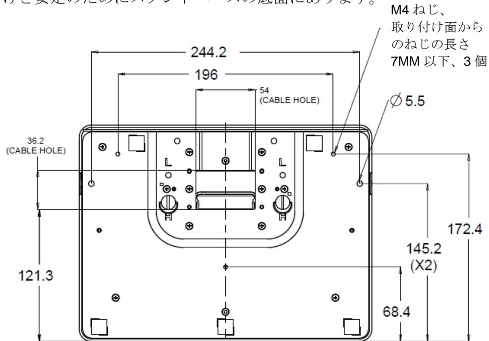
17型モニターの場合、M4ねじ用穴3個が付いている取り付けパターンが取り付けと安定のためにスタンドベースの底面にあります。
