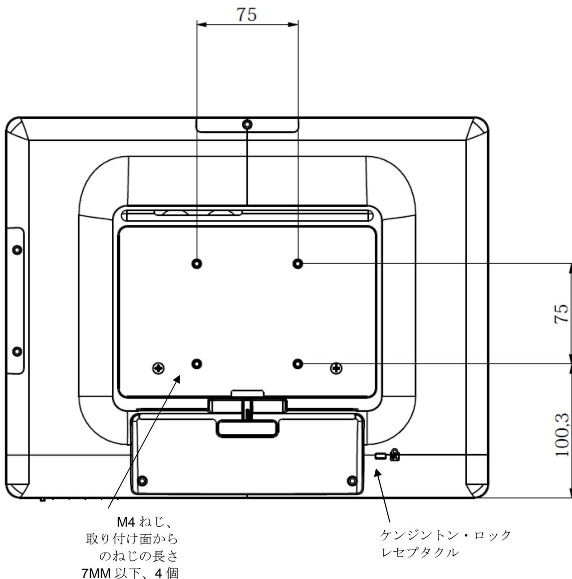
17型タッチモニターにはM4ねじ用穴75x75mm 4個が付いている取り付けパターンがモニターの裏面にあります。プラスドライバーを使ってスタンドを取り外し、実装インターフェイスにアクセスします。VESA FDMI準拠の順番は次のようにコード化されています：VESA MIS-D、75、C。
