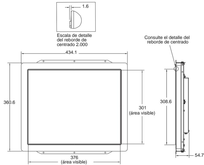
\*Las dimensiones indicadas corresponden sólo a no táctil, AccuTouch y IntelliTouch. Agregue 4 mm a las dimensiones para SecureTouch.
