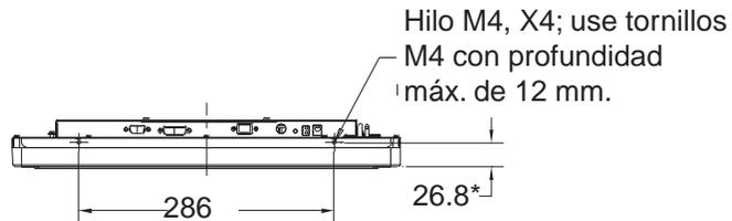
\*Las dimensiones indicadas corresponden sólo a no táctil, AccuTouch y IntelliTouch. Agregue 4 mm a cada dimensión para SecureTouch.
