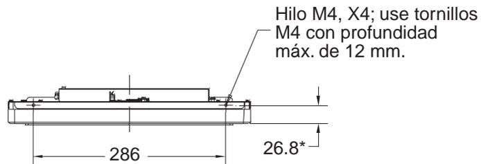
\*Las dimensiones indicadas corresponden sólo a no táctil, AccuTouch y IntelliTouch. Agregue 4 mm a cada dimensión para SecureTouch.
