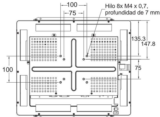
**NOTA:** El dibujo anterior muestra la interfaz de montaje VESA después de la remoción de la cubierta de montaje y de la base.
